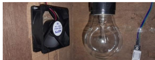
Gambar 3.2.4. Kipas menyala saat lampu mati dan suhu masih di atas ambang batas
