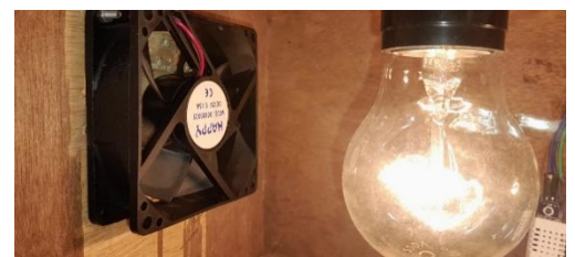
Gambar 3.2.5. Kipas mati saat lampu menyala setelah suhu turun dan kembali ke dalam rentang ideal
