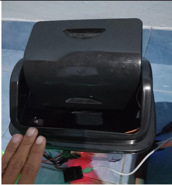
Gambar 3.2.1. (Rancangan Bak Sampah Otomatis)
