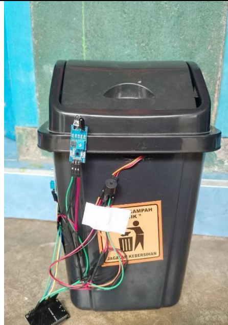
Gambar 3.1. (prototype sistem otomatisasi dan monitoring bak sampah)
